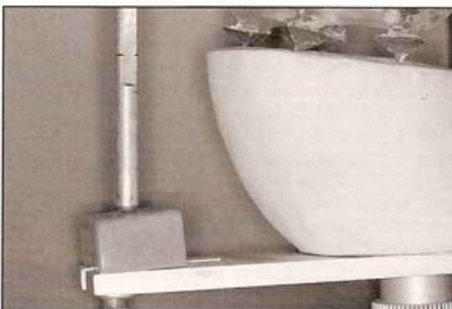
FIGURA 7 - Com uma aproximação maior, observação do contato entre pino e mesa incisal.
